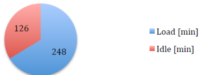
Figuur 4: Duty cycle van een boorinstallatie, meting over 2 dagen (bron: A.Hak Drillcon)
